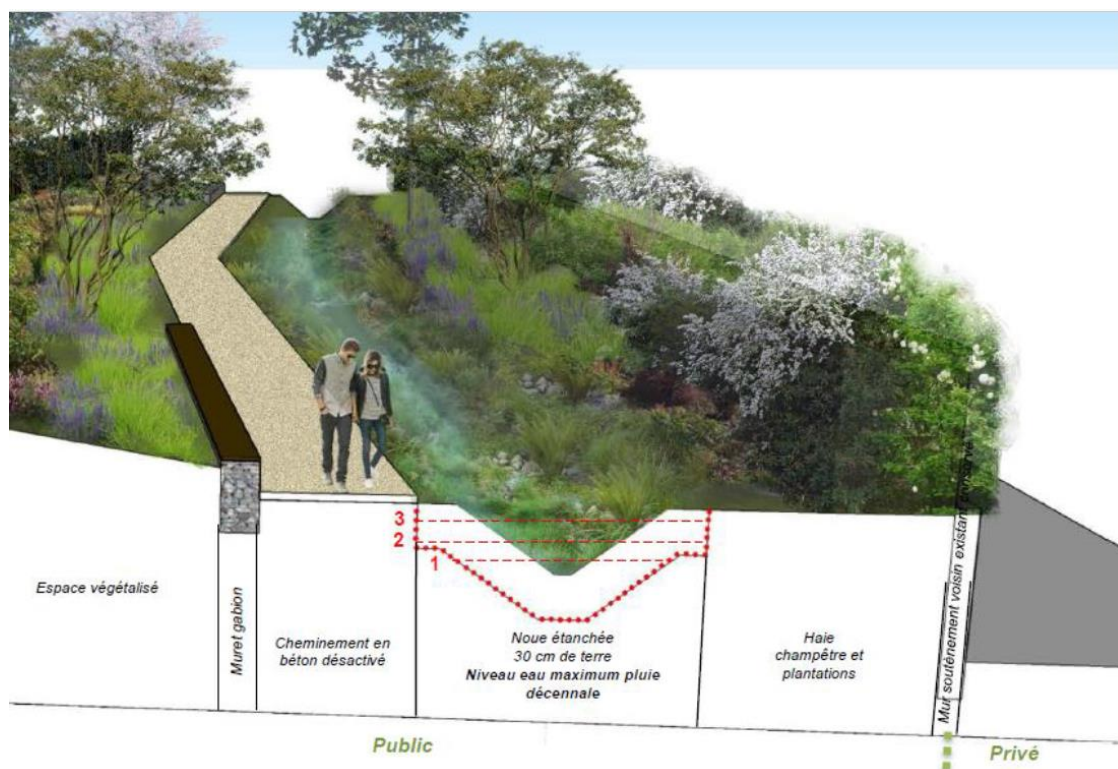
Figure 124 : coupe de principe de la noue de régulation (sud-ouest)
