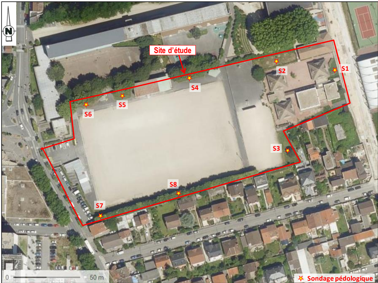
Figure 44 : Localisation des sondages réalisés (Fond de plan : Géoportail)
