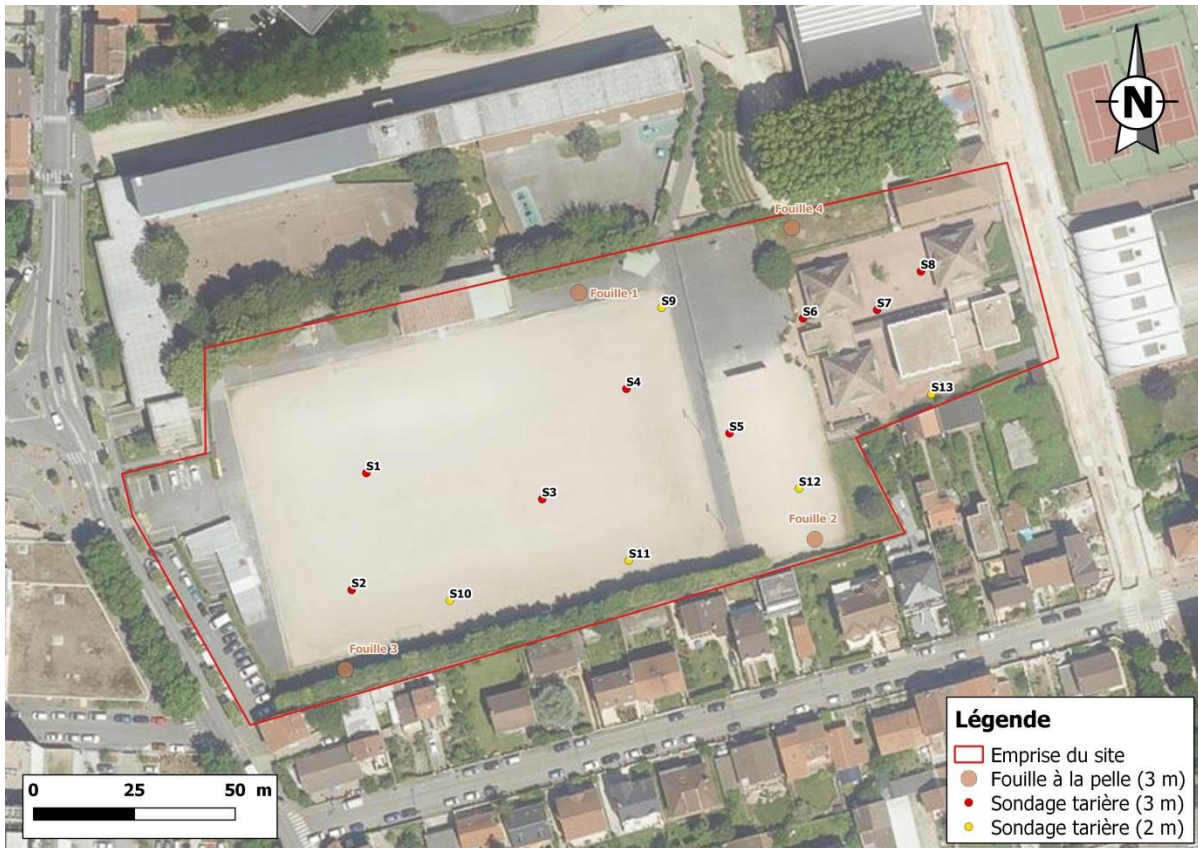
Figure 78 : Localisation des sondages.
