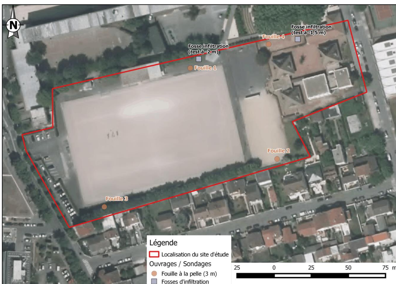
Figure 2 : Plan d'implantation des fosses d'infiltration et des fouilles au droit du site d'étude (fond de plan : Géoportail)
