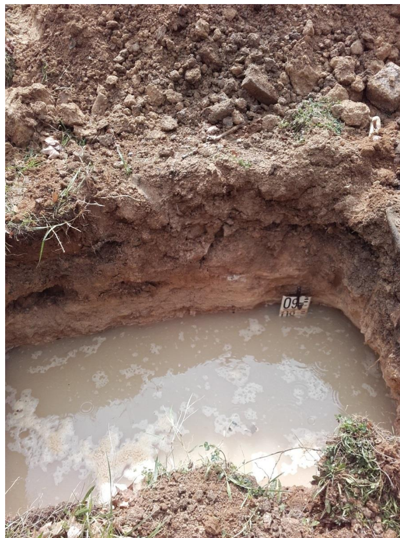
Photographie 2 : Fosse d'infiltration 2
