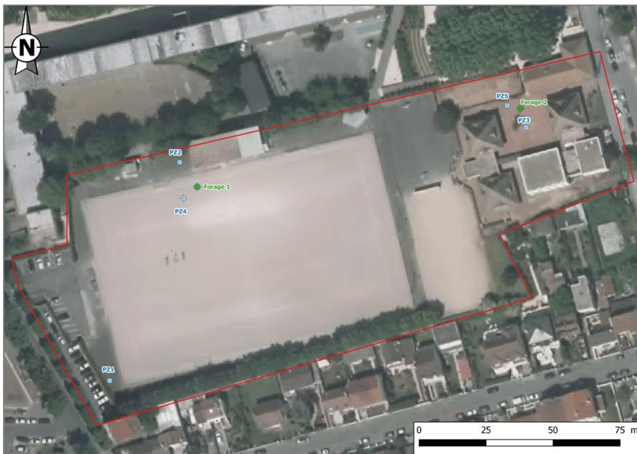
Figure 22 : localisation des forages et piézomètres
