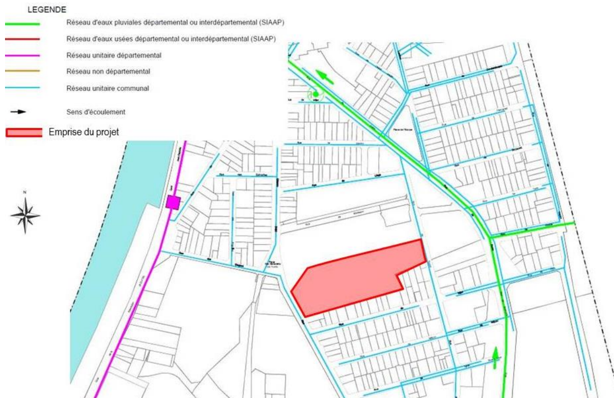
Figure 58 : réseaux d'assainissement (Source : PLU)
